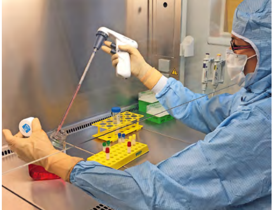
An der Reinraumbank des Translationszentrums „Regenerative Therapien“ in Würzburg werden mit viel Handarbeit Implantate aus patienteneigenem Knorpelmaterial hergestellt. Fotos: Tanja Kraus/Uniklinikum Würzburg
